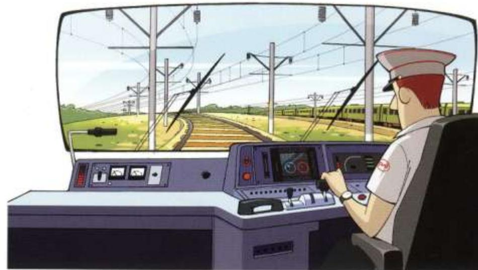
с какой скоростью ехать, где останавливаться, где ускорять движение, а где надо притормозить. Монитор покажет, свободна ли дорога и близко ли станция. Ещё у машиниста в кабине есть радиостанция, по ней он может разговаривать с дежурными на станциях или с начальником поезда.
